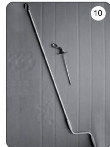
Korba, przegub Cardana 45° lub 90° z uchem [10].
